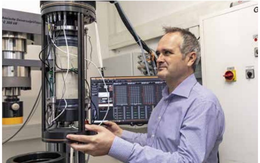
Forschung im Labor: Einbau von Gesteinsproben in das Triaxialgerät
