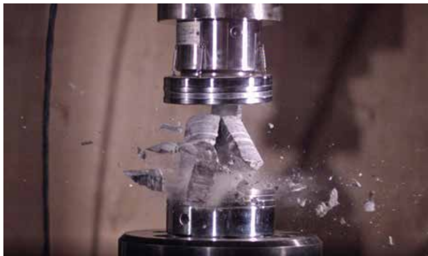
Versuche im Labor: Momentaufnahme des Bruchs einer Gesteinsprobe im Einaxialen Druckversuch
