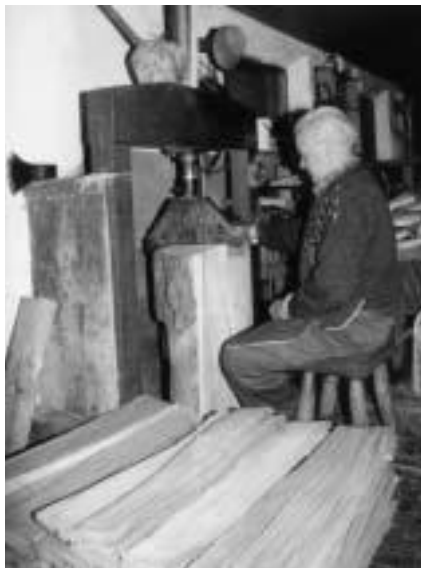
Der Schindelklieber Rudolf Lempfrecher am hydraulischen Kliebeisen
